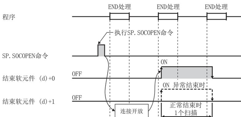
可以打开参数中无设置 (协议栏为空) 的连接以使用。该情况下, 应将 (s2) +0设为8000H, 在 (s2) +2~ (s2) +9中指定开放处理的内容。
