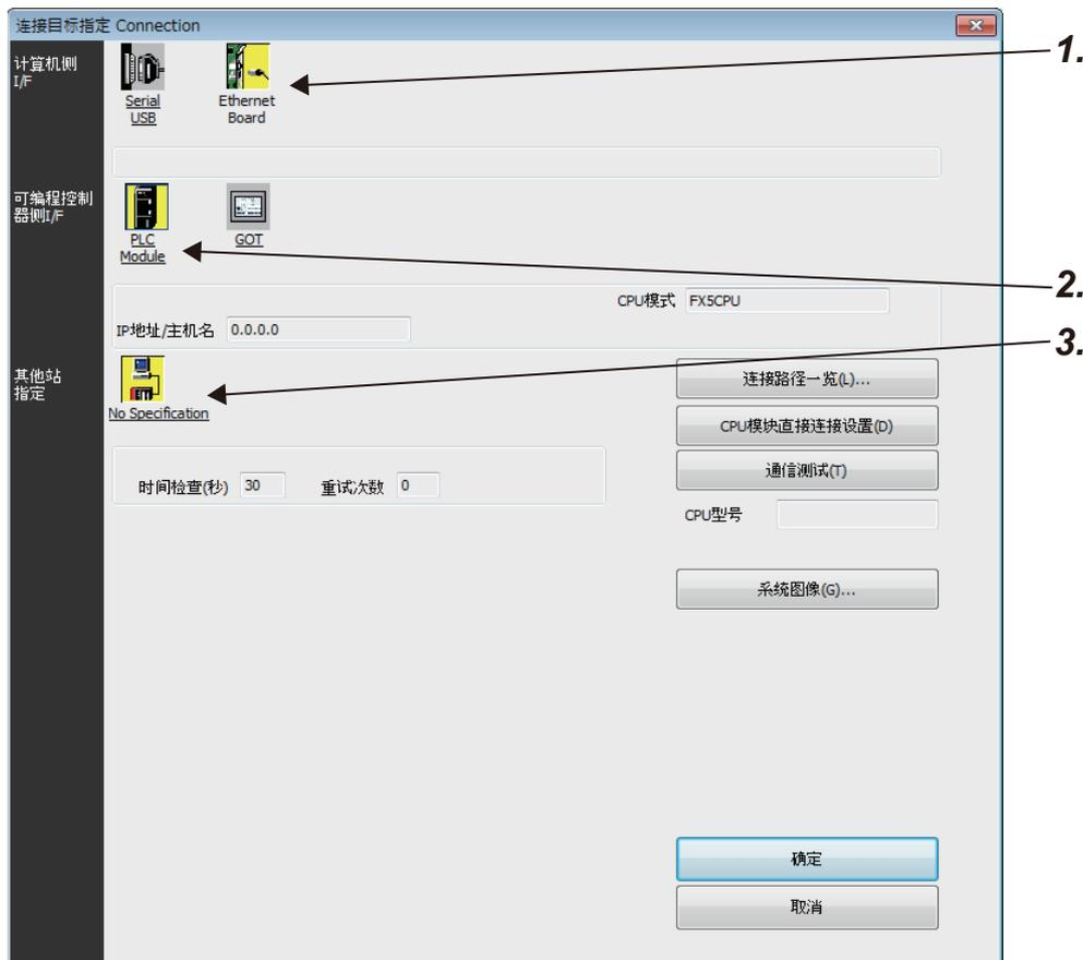
1. 将计算机侧I/F设置为“Ethernet Board”。
