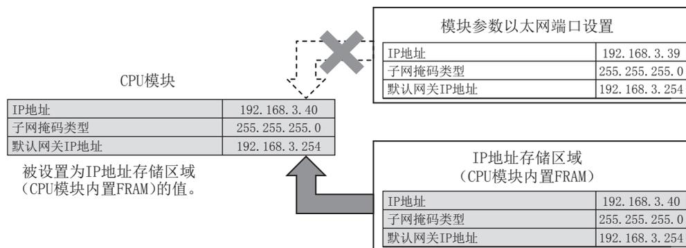
【使用模块参数以太网端口设置时(IP地址存储区域清除)】
