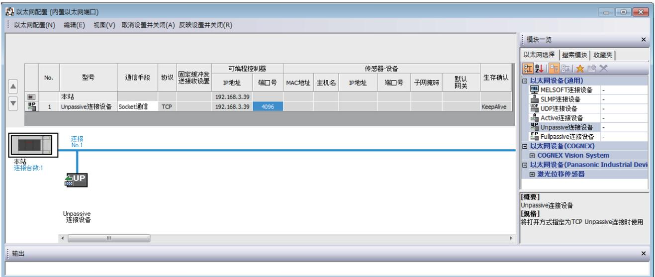
• 将“模块一览”的“Fullpassive连接设备”或“Unpassive连接设备”拖放到画面左侧，并进行如下设置。
