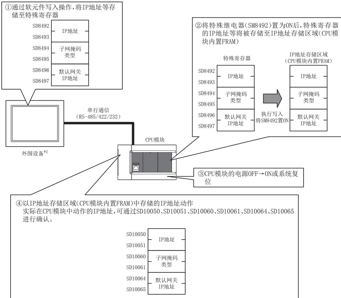
\*1 除了外围设备之外，通过链接功能或MX Component、MX Sheet更改特殊软件元件的值，也可以使用IP地址更改功能。关于链接功能的详情，请参照 MELSEC iQ-F FX5用户手册(串行通信篇)。关于MX Component、MX Sheet的详情，请参照各产品的手册。
