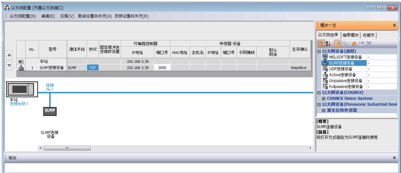
3. 将“模块一览”的“SLMP连接设备”拖放到画面左侧。在“协议”中选择适合对方设备的协议(TCP或UDP)。在“端口号”中设置本站端口号 (设置范围: 1025~4999、5010~65534)。此外, 5000~5009已被系统使用, 请勿指定。
