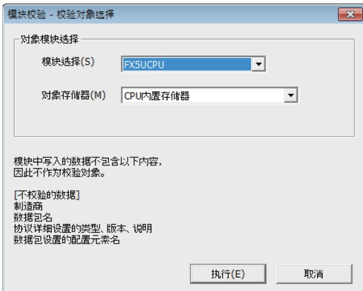
11. 将已设置的参数写入到CPU模块中后，复位CPU模块，或将电源置为OFF→ON。
