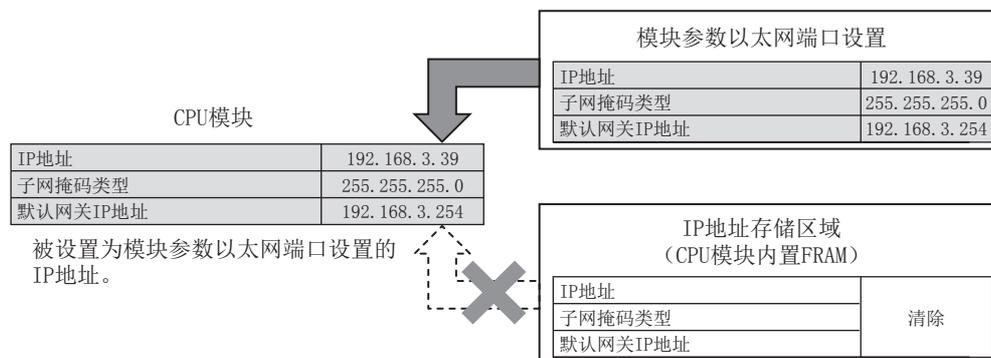
IP地址存储区域被清除（IP地址更改功能动作中标志（SM8498）为OFF）时，模块参数以太网端口设置变为有效。
