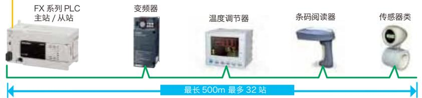
\*1: 使用MODBUS通讯时FX3SA/FX3S、FX3GA、FX3GE、FX3GC从第一批产品开始适用; FX3G Ver. 1.30以上、FX3U(C) Ver. 2.40以上, 且只能连接1ch
